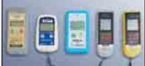
②空間の放射線量を調べる 簡易放射線測定器「はかるくん」(シンチレーション式サーベイメータ) 空間の放射線量を測るもの。身の回りの放射線(ベータ(β)線、ガンマ(γ)線)を調べることで学用品用の測定器です。(単位:μSv/h)
