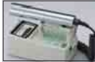
②空間の放射線量を調べる シンチレーション式サーベイメータ 空間の放射線量を測るもの。放射線による人体への影響を調べるのに利用します。(単位:μSv/h)
